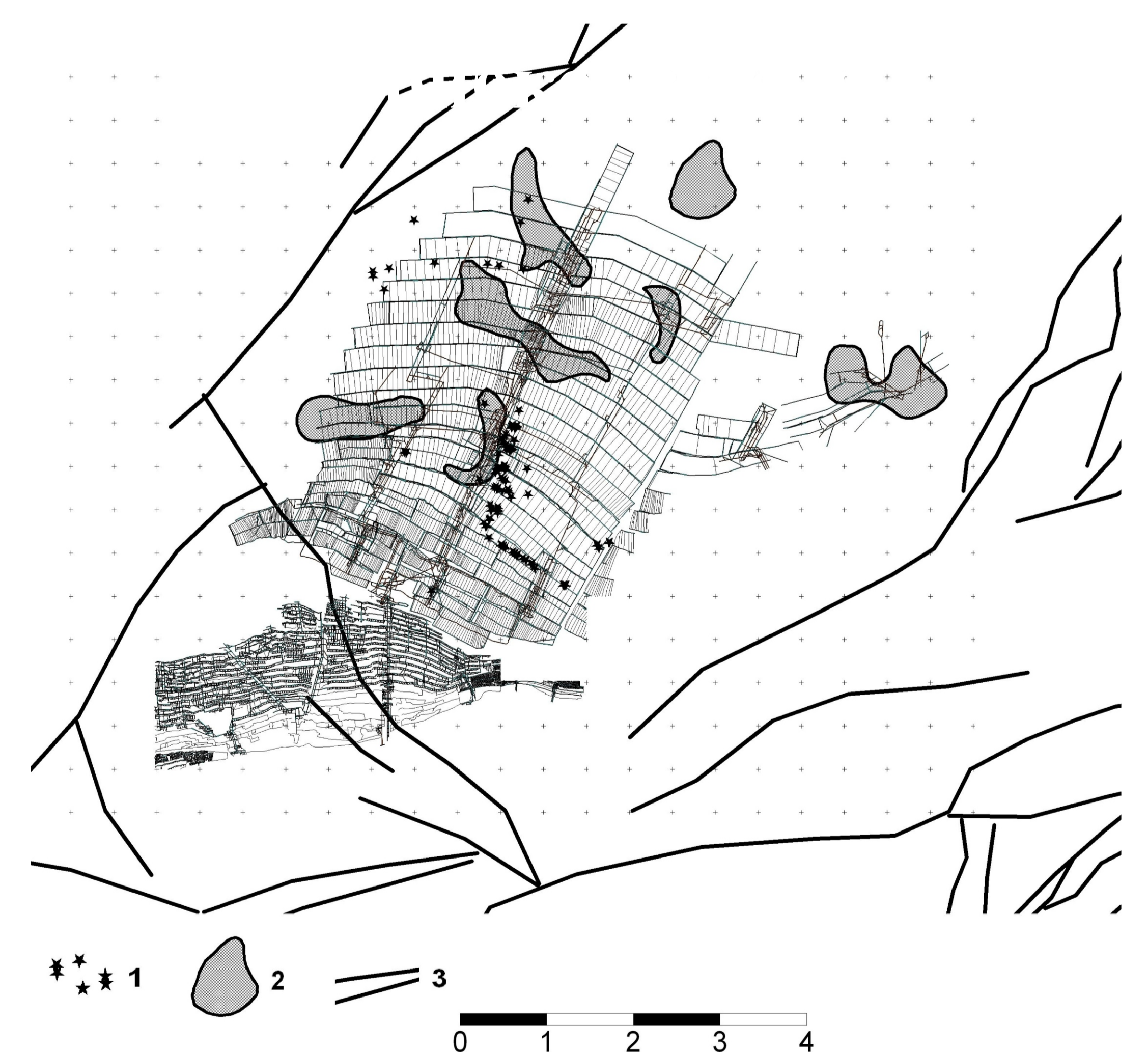
Схема зіставлення плану гірничих робіт (шахта «Ім. О.Ф. Засядька») по пласту ІІ з основними тектонічними порушеннями: 1 - газодинамічні явища, 2 - прогнозні зони скупчення метану, 3 - тектонічні порушення
