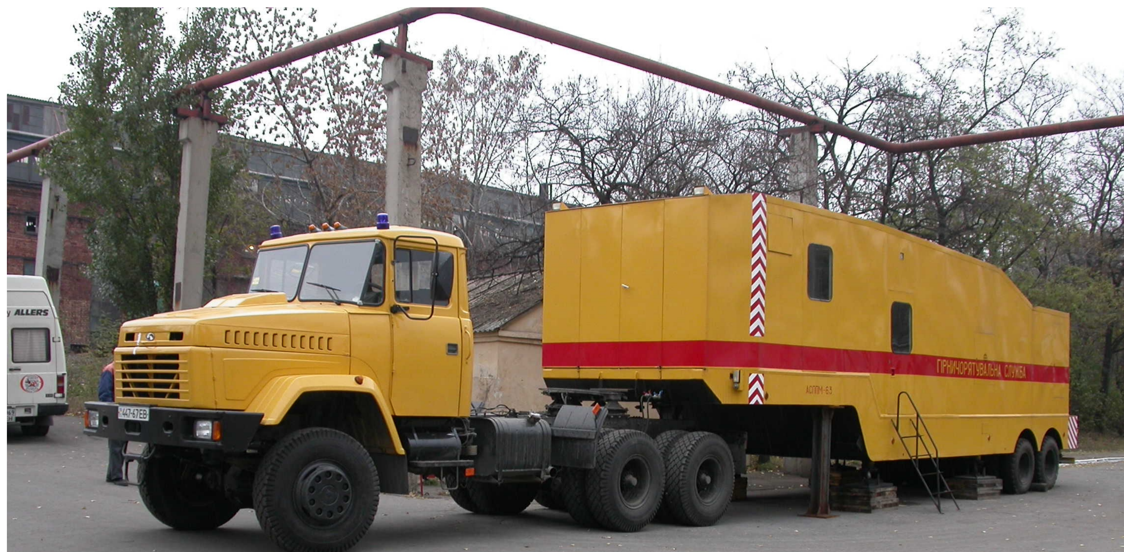
Універсальна аварійно-рятувальна мобільна підйомна установка АСППУ 6,3
