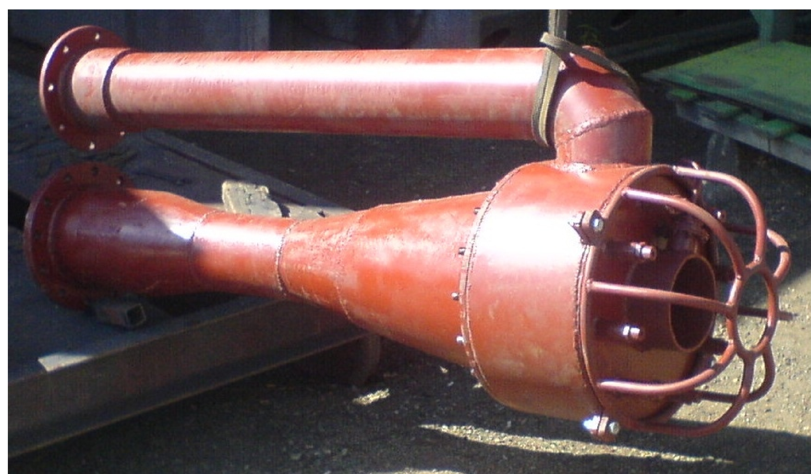
Ґрунтозабірний пристрій ежекторного земснаряда
